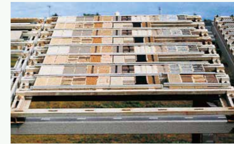
<宮古島暴露試驗場> 暴露在比一般地區約3倍的紫外線和風雨更苛刻的條件下，實施室外暴露試驗，觀察其經過。
